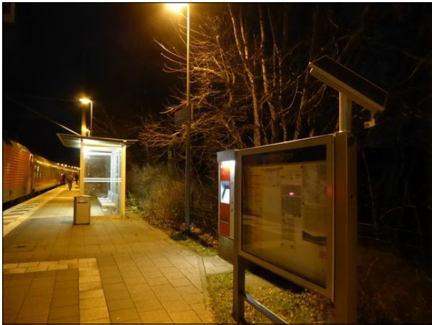
Abbildung 31: Die durch Solarzellen mit Strom versorgte Vitrinenebeleuchtung an Gleis 2 in Einfeld funktionierte nicht.
